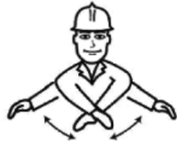
f) Faena terminada
